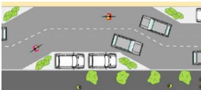
La chicane permet de décaler l'axe de la chaussée avec une déflexion significative de la trajectoire et un déport latéral important. Outre le fait de réduire les vitesses pratiquées, elle permet de créer une rupture dans le linéaire de la voie et d'ajouter ou de renforcer d'autres fonctions de circulation ou de desserte.
